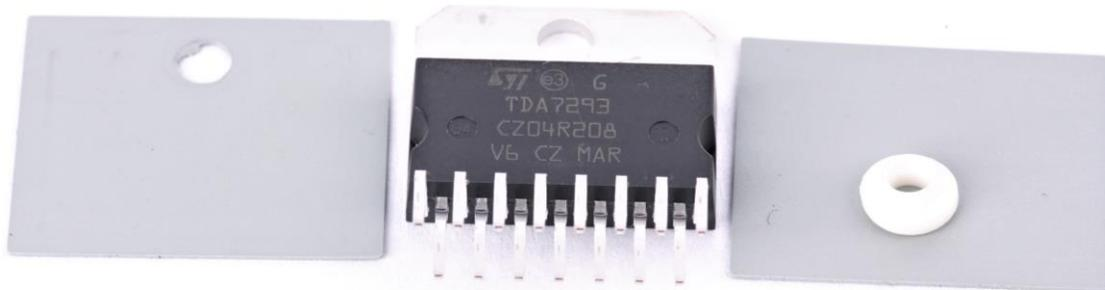
Auch ist es nicht einfach die Wärme vernünftig Abzuleiten! Ich habe mir Silicon Isolier Pads besorgt und diese dann mit Hilfe des Isoliernippel dann das Loch in den Pad Gestanzt was ganz gut funktioniert.
